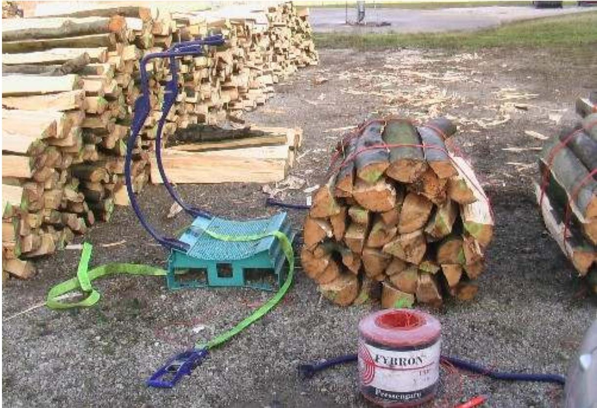
Abbildung 77: Arbeitsplatzbeispiel für das Stapeln und Bündeln mit einer Bündelhilfe, hier für 0,5 Rm-Bündel
