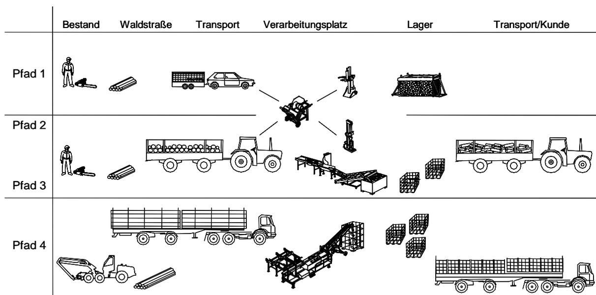
Abbildung 115: Schema der unterschiedlichen Scheitholzbereitstellungsketten
