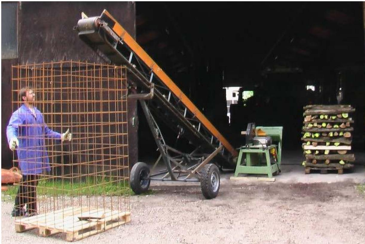
Abbildung 19: Befüllen der Gitterbox für die Schüttvolumenbestimmung
