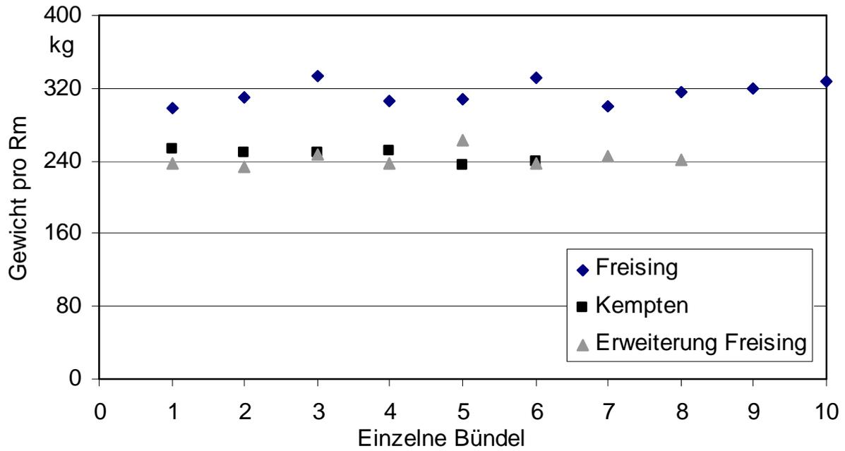
Abbildung 107: Gewichtsstreuung pro 1 Rm Bündel mit gespaltenem Fichtenholz (berechnet auf einen einheitlichen Bezugswassergehalt von  $w = 15\%$ )
