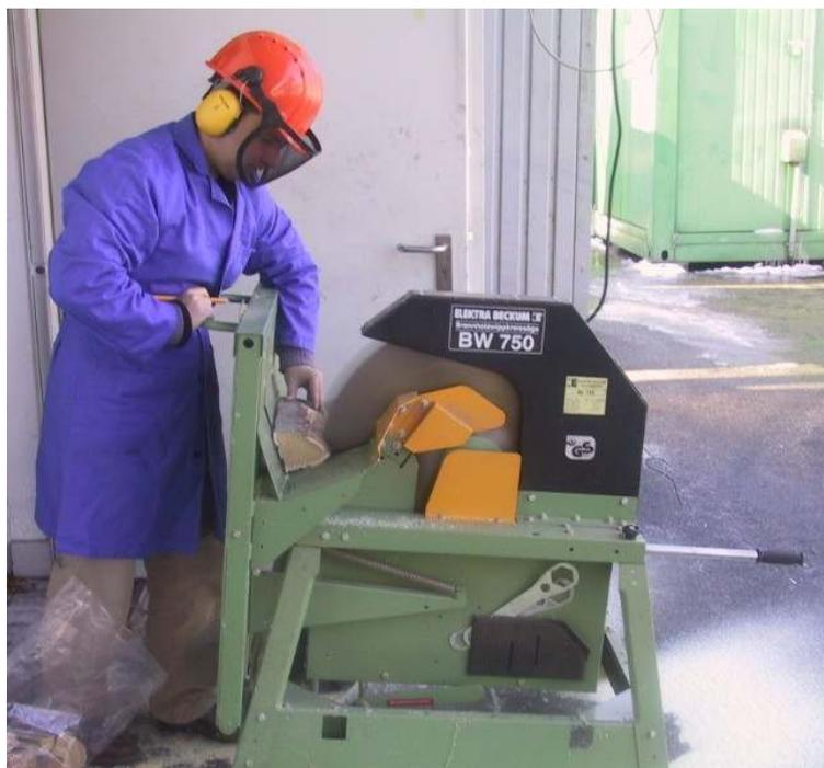
Abbildung 24: Probenahme mit Kreissäge für Wassergehaltsbestimmung
