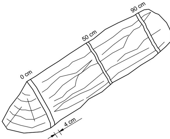
Abbildung 25: Probenahmepositionen für die Wassergehaltsbestimmung am Meterscheit
