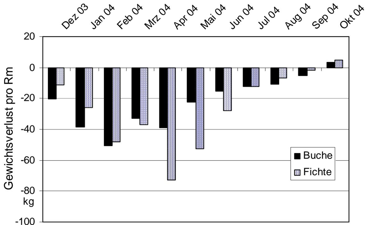
Abbildung 91: Trocknungsrate in Litern bzw. kg pro Monat bei frisch eingelagerter Buche und Fichte im 2. Versuchsjahr (2004). Lagerart: außen, abgedeckt, gespalten, Standort: Freising)
