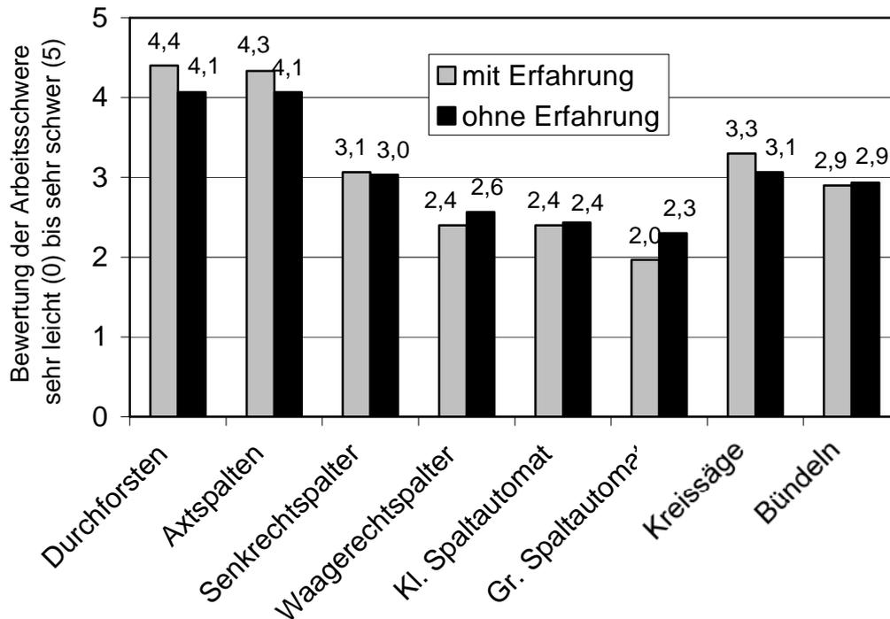
Abbildung 79: Ergebnisse der Befragung zur Einschätzung der Arbeitsschwere; Einteilung von sehr leicht (0) bis sehr schwer (5). Beim Senkrechtspalter erfolgte keine Differenzierung in große oder kleine Geräte
