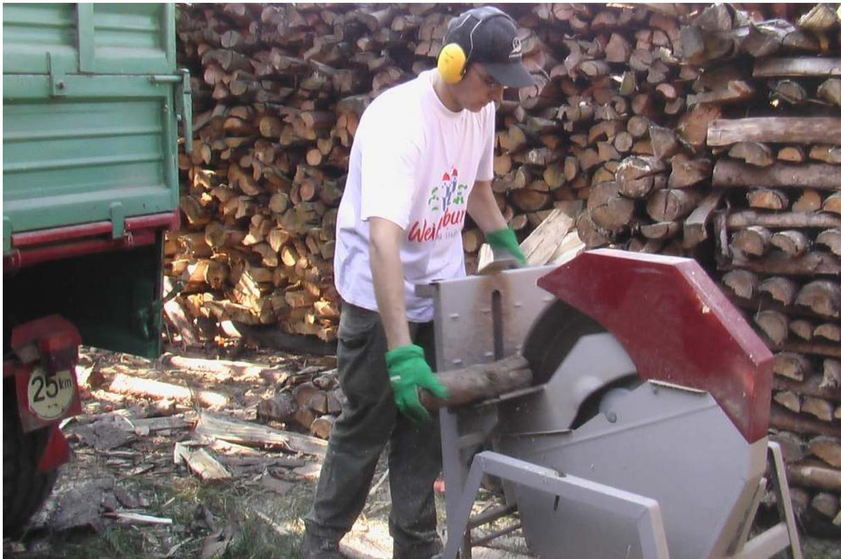
Abbildung 75: Arbeitsplatzbeispiel für Zeitstudie zum Trennschnitt mit der Kreissäge (KR).
