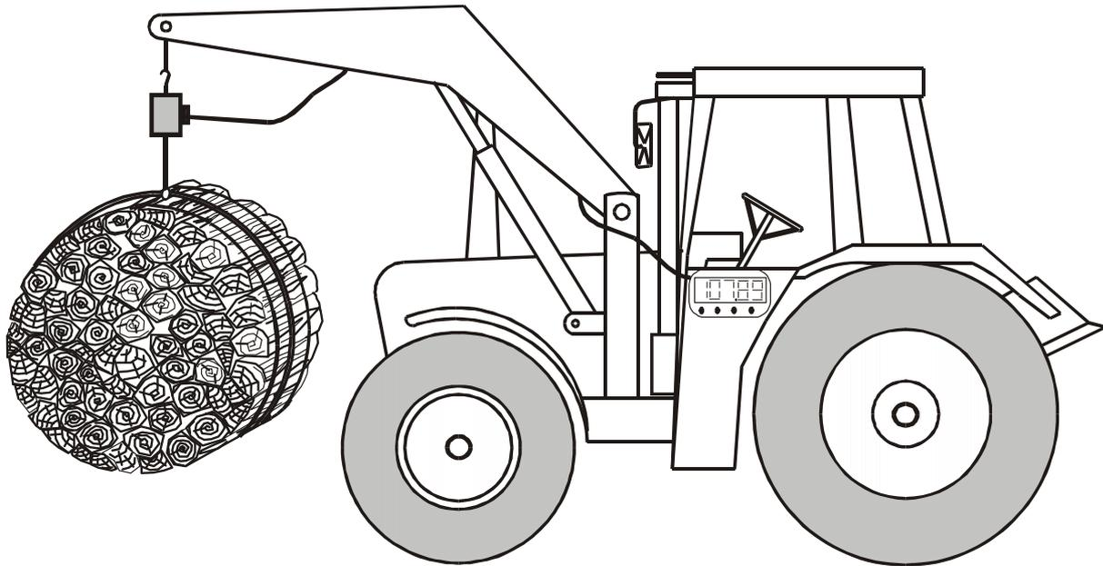
Abbildung 28: Die regelmäßige Wiegung der Meterscheit-Bündel (schematisch)
