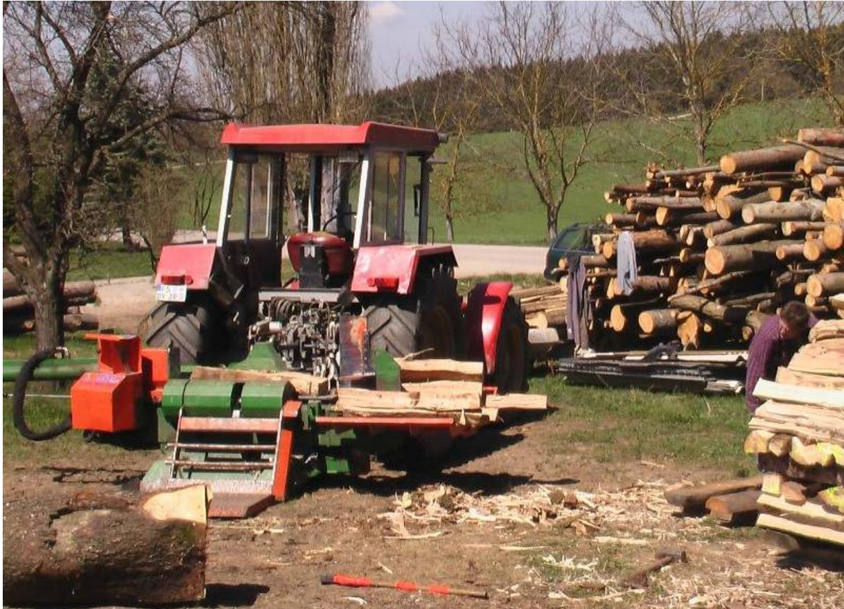
*Abbildung 62: Arbeitsplatzbeispiel für Zeitstudie zum Spalten mit großem Waagrechtspalter (hier: Hydromax 24 t, Fa. Posch)*
