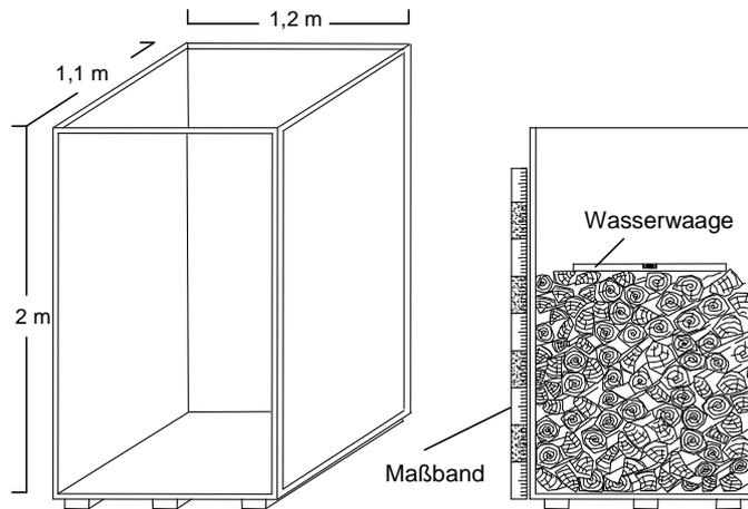
Abbildung 18: Höhenmessung für die Volumenbestimmung im Standard-Messrahmen
