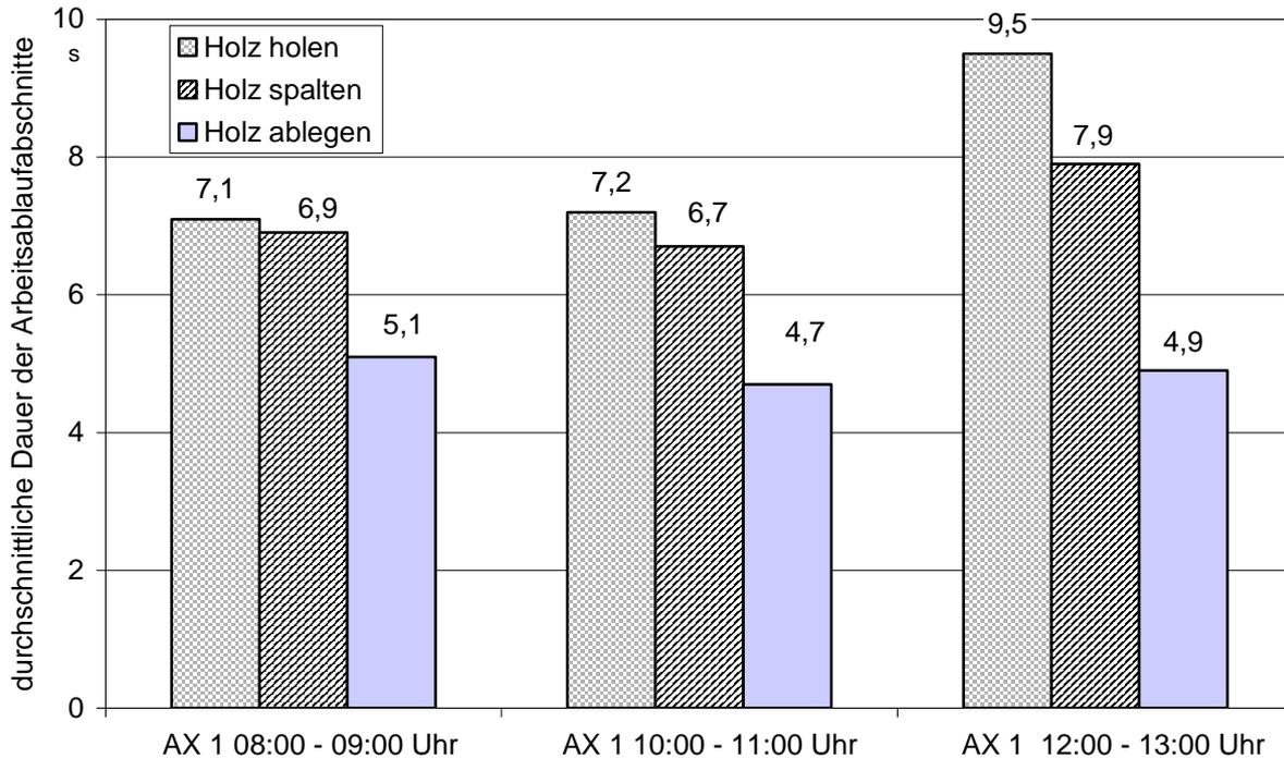
Abbildung 51: Durchschnittliche Dauer der drei einzelnen Arbeitsablaufabschnitte beim manuellen Spalten mit der Axt (AX 1) bei der Holzart Fichte
