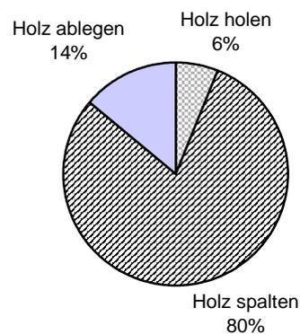
Abbildung 50: Die zeitliche Verteilung der Arbeitablaufabschnitte der Teilstudien zum Axtspalten (AX 1) und zum Spalten mit Spalthammer (SP 1 und 2)
