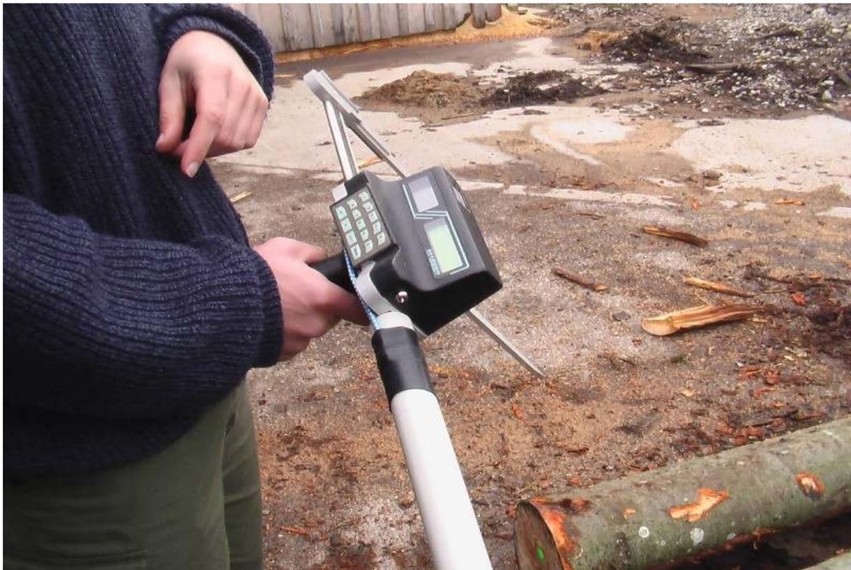
Abbildung 9: Elektronische Kluppe für die Durchmesserbestimmung
