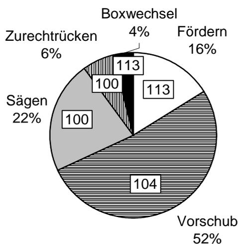
Abbildung 83: Teil-Belastungsindizes  $L$  und Arbeitszeitanteile der Ablaufabschnitte beim kleinen Spaltautomaten
