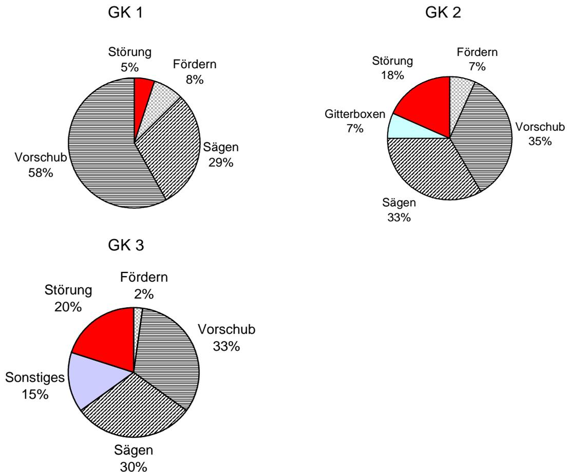
Abbildung 73: Zeitliche Verteilung der Arbeitsablaufabschnitte in den Teilstudien mit großen kombinierten Säge-Spaltmaschinen (GK). Zur Teilstudie GK 3 wurden Rohdaten einer früheren Untersuchung der LWF ausgewertet (Daten zu MALL [41])
